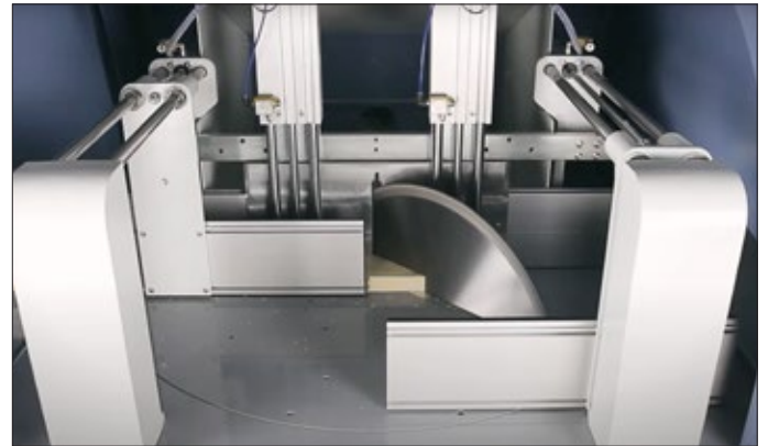
Automatic table rotation \pm 70^\circ ( \pm 80^\circ optional).
